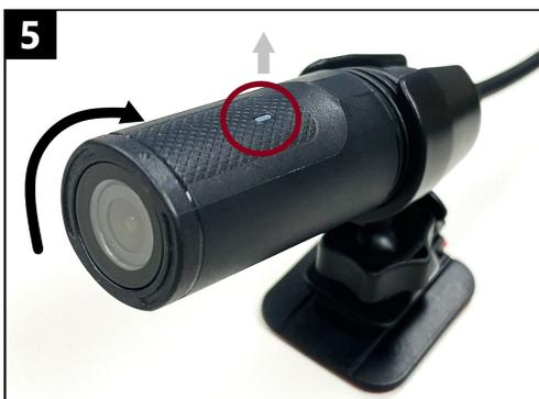
Drehen Sie die Kamera so, dass die LED-Aufnahmeanzeige nach oben zeigt.
