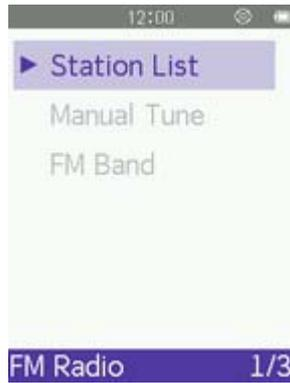
2. MP710은 주파수를 자동으로 스캔하여 주파수가 잡히는 30개의 채널을 프리셋으로 저장합니다. (CH01 ~ CH30)
