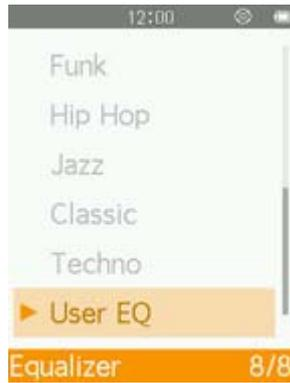
4. 버튼을 눌러 5 가지 대역(80Hz, 200Hz, 1KHz, 4KHz, 8KHz)중 한 가지를 선택하십시오.
