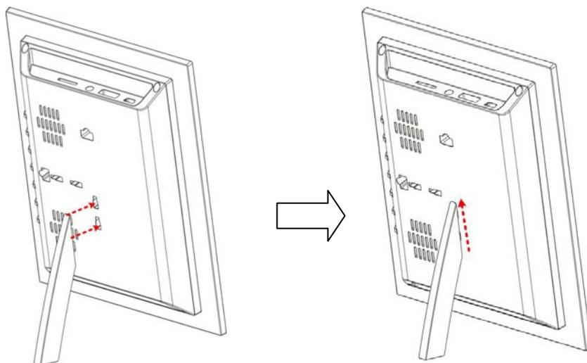
Abb. 3: Anbringen des Standfußes an dem **PF710** (Hochformat)
