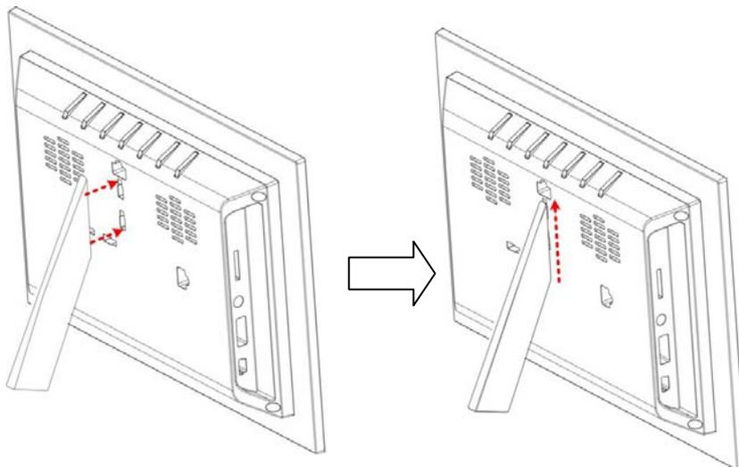
Abb. 2: Anbringen des Standfußes an dem PF710 (Breitformat)
