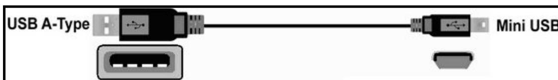
Abb. 9: Mini USB mit USB A-Typ-Kabel
