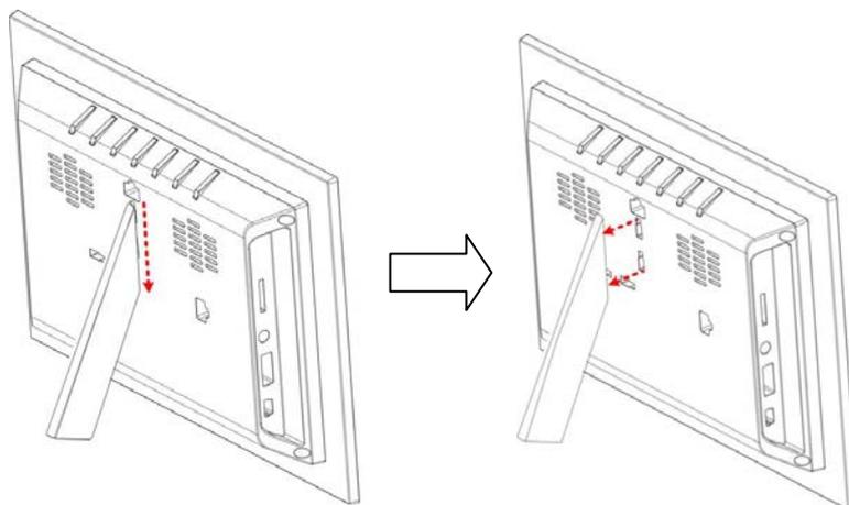
Abb. 5: Entfernen des Standfußes von dem **PF710** (Breitformat)
