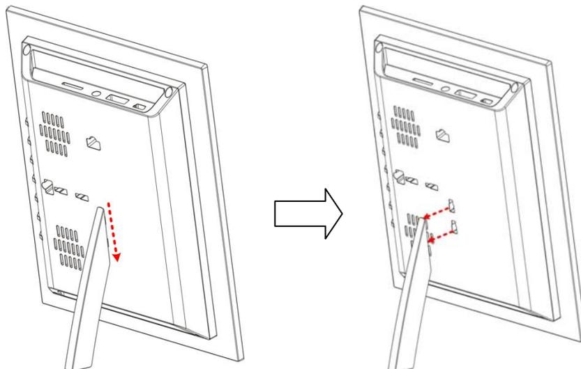
Abb. 6: Entfernen des Standfußes von dem PF710 (Hochformat)
