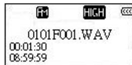
4. Aufnahmen von UKW Radio werden mit fortlaufenden Dateinamen in der Reihenfolge **[Month/DayF001.WAV]**, **[Month/DayF002.WAV]** usw. benannt.
