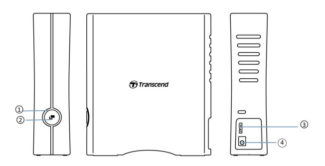
① LED 指示燈 ② 功能鍵 ③ USB 連接埠 ④ DC 12V 插孔
